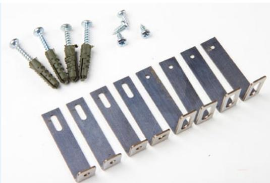
Ответная часть уголков имеет проточку для регулировки зазора от 81 мм до 89 мм между потолком и корпусом светодиодной панели, что позволяет выравнивать панель при установке. Величина зазора позволяет скрытно разместить источник питания за светодиодной панелью.
